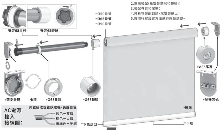
注: 帶"\*"號的是非本電機標配部件(可訂製零件) 1.準備卷管,並按卷管直徑選擇對應的皇冠,轉輪和尾塞。
